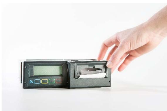
4.) Nachdem Sie die Papierrolle korrekt eingesetzt haben, schieben Sie den Drucker mit geöffneter Klappe wieder zurück in die Druckeröffnung.
